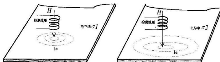
HIGO. 1-2 variaciones de corrientes de Foucault debido a la diferente conductividad
